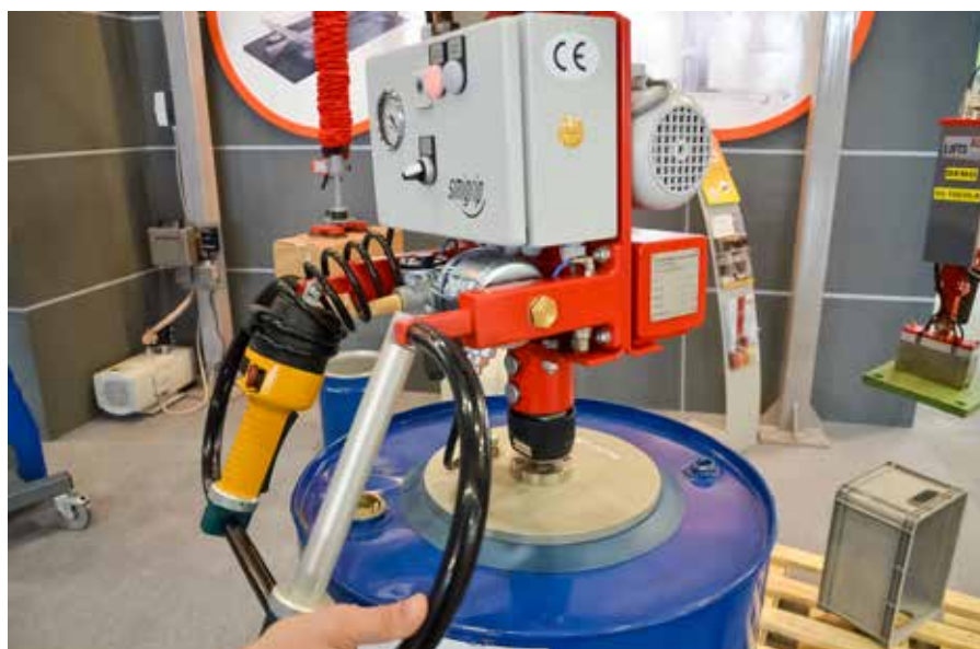
Zawiesia przyssawkowe (m.in. Smigrip) pomagają w obsłudze „trudnych” ładunków (fot. MJ)
