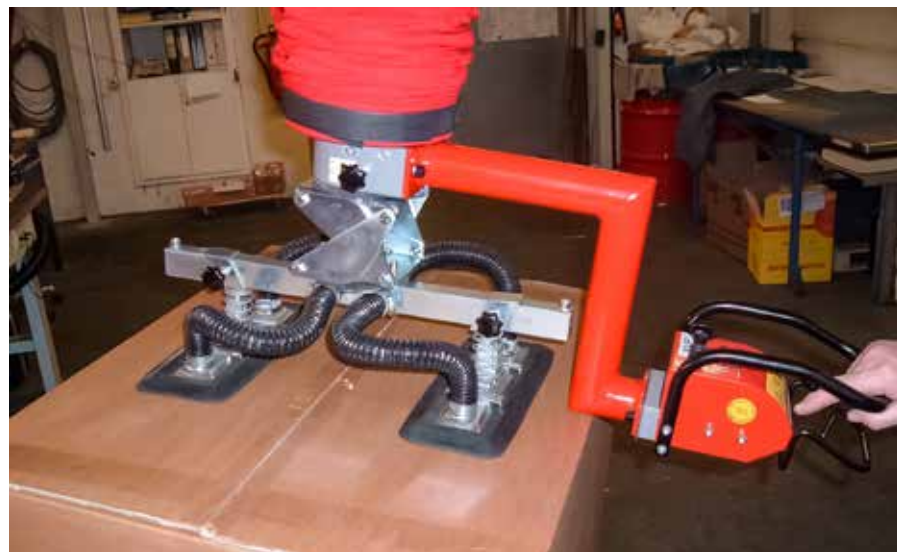
Często urządzenia posiadają wymienny osprzęt w postaci dodatkowych chwytaków czy przyssawek (fot.ID Lifting)
