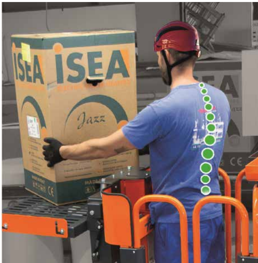
Faraone Elevah Picking. Operator stoi stabilnie na platformie zabezpieczony poręczą, podczas gdy pobierany towar bezpiecznie transportowany jest na półce ładunkowej sterowanej elektrycznie. (fot. Faraone)
