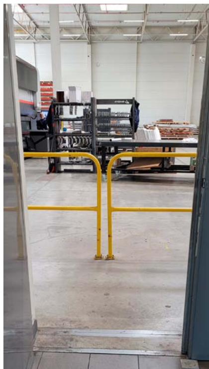
Zdj. 1. Przykład barierek zabezpieczających przed wtargnięciem pieszego na drogę transportową [z lewej widok od strony wejścia na halę; z prawej widok od strony hali]
