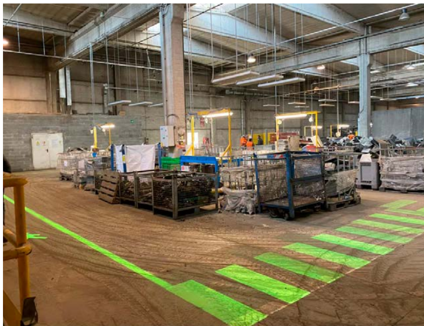
Zdj. 8. Przykład oznaczenia poziomego w technologii LED [za https://www.4safety.pl/post/projektoryled ]
